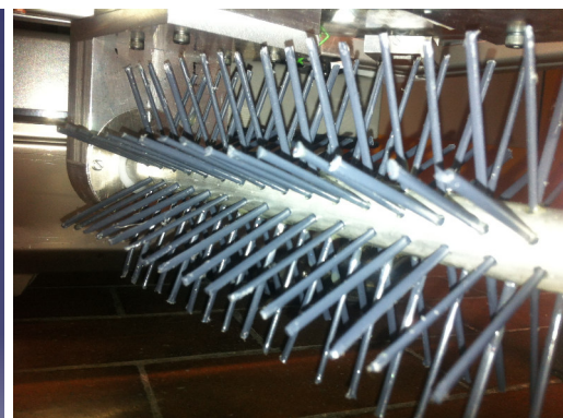
(b) Eingebaute Bürste mit eingeklebten Borsten
