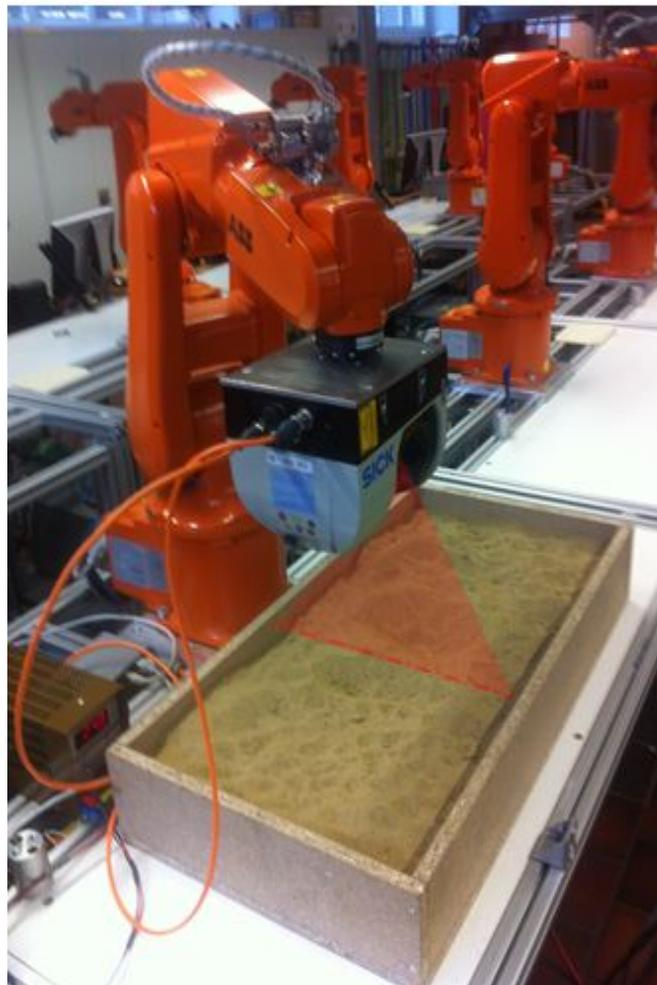
Abbildung 3.1: Nachbearbeitetes Bild: ABB Roboter mit montiertem SICK-Laser bei der Feldaufnahme
