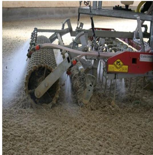
Abbildung 1.2: Sand einer Reithalle wird von einer Anhängerkonstruktion geglättet[8]
